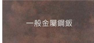
一般環境下放置 96小時，一般冷熱軋鋼板或黑皮板即產生鏽痕
